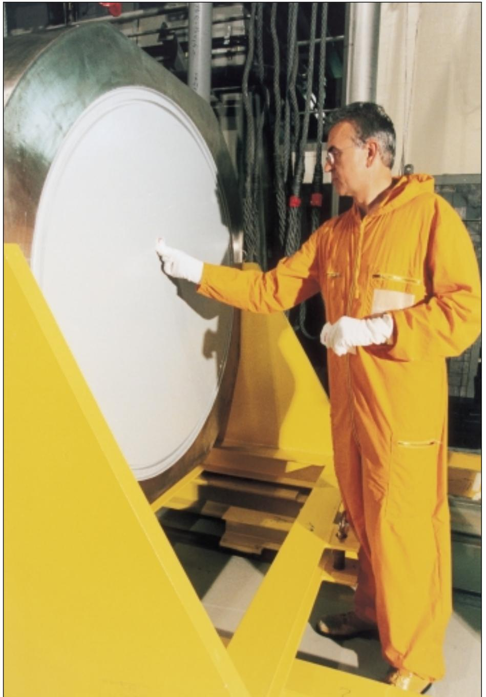
*Zur Überprüfung der Kontamination der Oberfläche des Behälters werden sogenannte Wischtests durchgeführt. Die Wischproben werden anschließend auf Radioaktivität ausgemessen. Nur wenn die vorgegebenen Werte eingehalten sind, darf der Behälter aus dem Reaktorgebäude abtransportiert werden*
