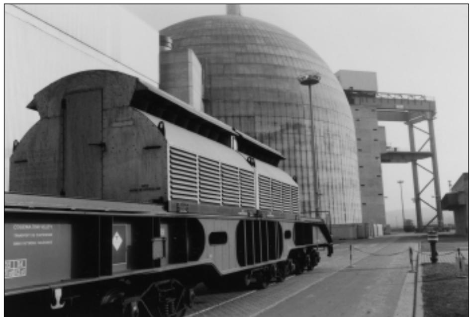
Abtransport eines Behälters für abgebrannte Brennelemente aus dem Kernkraftwerk Philippsburg zur Wiederaufarbeitungsanlage in Frankreich. Der Behälter wird unter einer verschiebbaren Haube befördert
