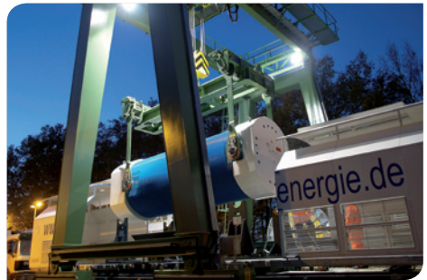
Umladung eines Castor-Behälters von Schienenfahrzeug auf Straßentransporter
