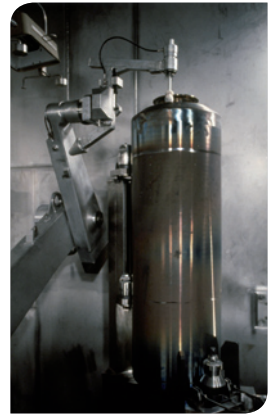
HAW-Kokille in einer „Heißen Zelle“ in La Hague
